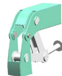
La movimentazione delle sezioni avviene attraverso sistemi di bielle e leve azionate da cilindri oleodinamici.
