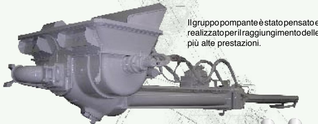
I cilindri pompanti sono stati sovradimensionati per alte pressioni.
