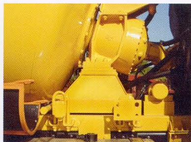
Il riduttore è epicicloidale a 2 stadi. La trasmissione è idrostatica a circuito chiuso composta da una pompa a pistoni assiali, da un motore a pistoni assiali con trasduttore di velocità integrato e sistema elettronico CSD ( Constant Speed Drive )
